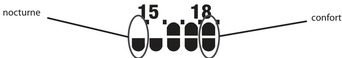
Le valeur de la température de confort est celle sélectionnée avec le bouton de réglage (A) sur «confort». Le valeur de la température nocturne ou réduite est celle sélectionnée avec le bouton de réglage (A) sur «nocturne».
